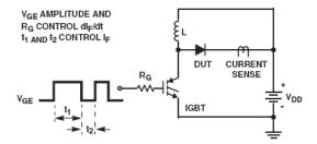
FIGURE 8. t<sub>rr</sub>TEST CIRCUIT
